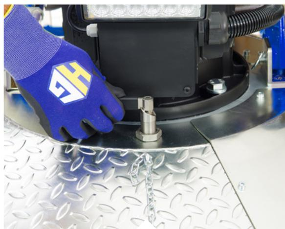
Leva azionamento sistema **DCT**.
